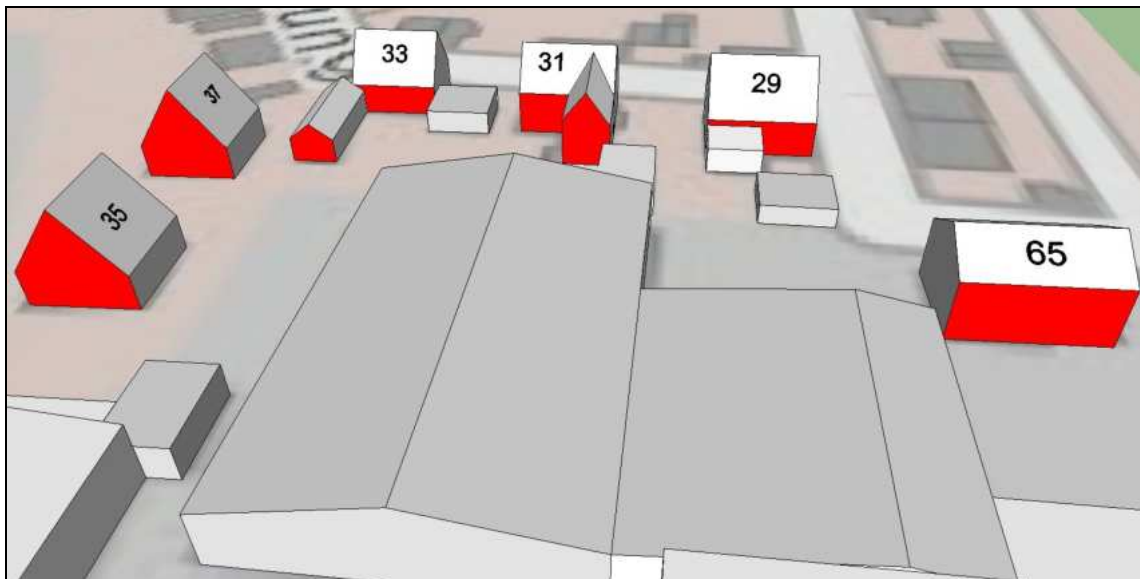
Abb. 6: Beurteilungsrelevante Südfassaden (rot) der nächstgelegenen beurteilungsrelevanten Wohnbebauung in Waldershof
